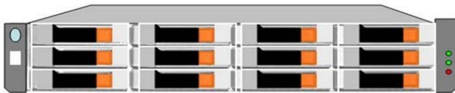
圖 8 商用入門款: 12 顆 3.5 吋 SAS 硬碟 (max. capacity: 12TB)
